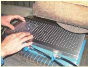
①ワークを吸引口に数多くかかるように載置する。
