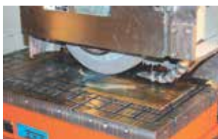
真空チャック機能を利用したの 真ちゅう研削加工例
