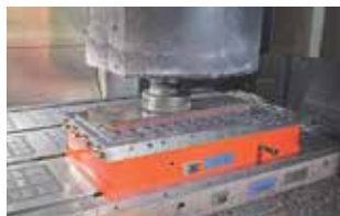
永電磁チャック機能を利用したの フライス加工例
